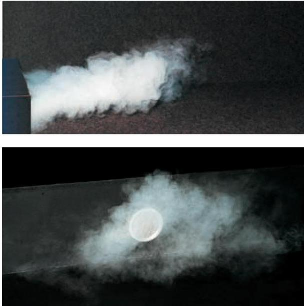
**Bild 7: Strahlusbildung durch Rauchprobe sichtbar, oben: Linearer Stufenquellauslass unten: Runder Stufenquellauslass**
