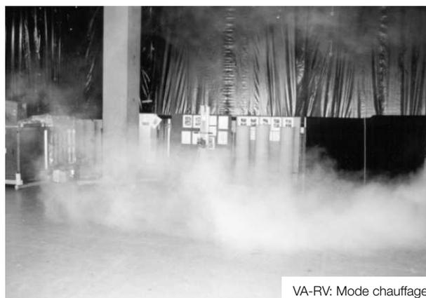
Figure 4: Propagation des jets d'air mise en évidence par un essai de fumée
