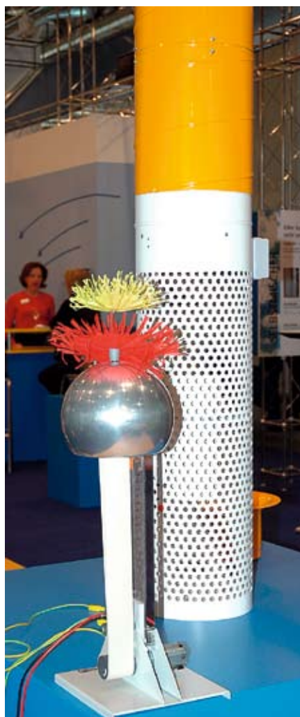
Die Papierschirmchen zeigen die Wirkung bei mit 40 000 Volt aufgeladener Luft. Links ohne Einfluss von leitfähiger Luft und rechts den Zusammenbruch der geladenen Statik, sobald – immer noch bei 40 000 Volt Aufladung – leitfähige Luft beigefügt wird.
