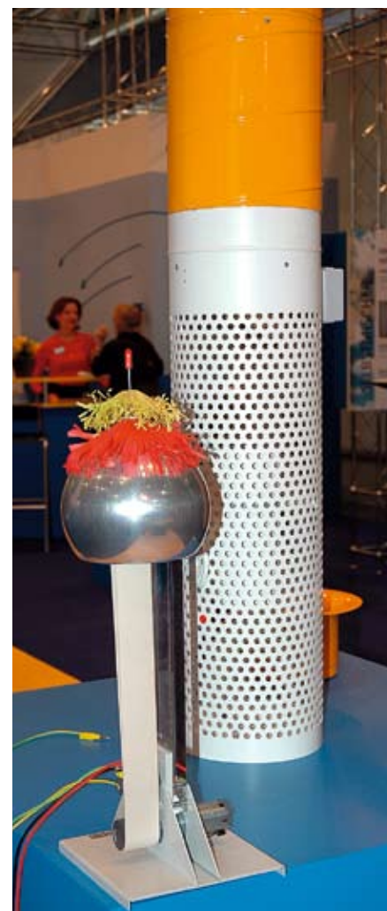
Die Papierschirmchen zeigen die Wirkung bei mit 40 000 Volt aufgeladener Luft. Links ohne Einfluss von leitfähiger Luft und rechts den Zusammenbruch der geladenen Statik, sobald – immer noch bei 40 000 Volt Aufladung – leitfähige Luft beigefügt wird.
