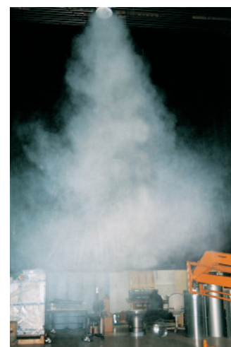
Rauchversuch «Heizfall» mit Einwirkung des Stützstrahls
