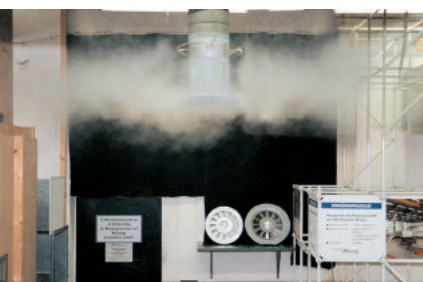
Rauchversuch «Kühlfall» mit horizontal austretender Luft.
