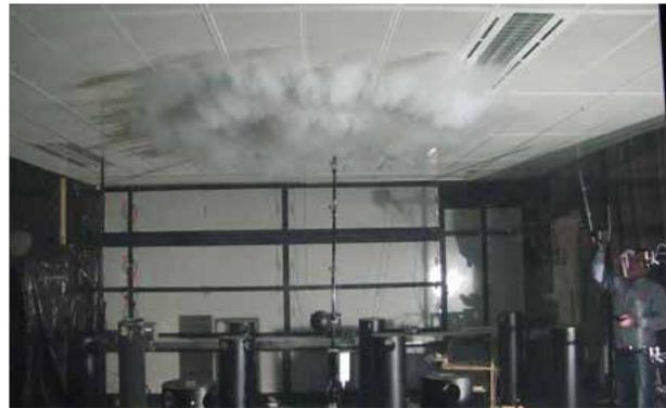
Figure 2: Schéma de diffusion visualisé par de la fumée
