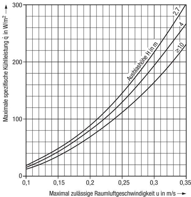
**Bild 8: Zweidimensionale diffuse Raumluftströmung für Wand- Luftdurchlässe, z. B. Linearer Wirbelauslass, Wandschlitzauslass, Breitflächerauslass, Weitwurfdüse, Brüstungsauslass, sowie für aktiven Deckenkühlkonvektor**
