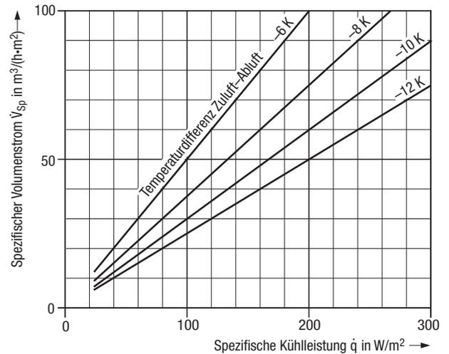
**Bild 6:** Zusammenhang zwischen spezifischer Kühlleistung, Temperaturdifferenz und spezifischem Luft-Volumenstrom
