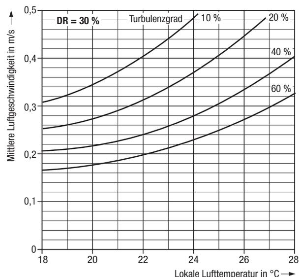
Bild 3: Zulässige mittlere Raumluftgeschwindigkeiten nach DIN EN ISO 7730 für Kategorie C, entsprechend Zugluftrisiko 30 %
