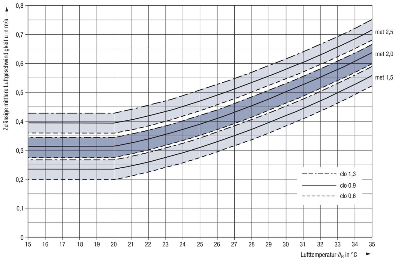
**Bild 9:** Zulässige mittlere Raumluftgeschwindigkeiten in Fertigungsstätten nach VDI 3802
