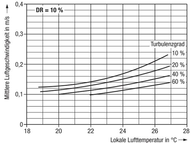
Bild 1: Zulässige mittlere Raumluftgeschwindigkeiten nach DIN EN ISO 7730 für Kategorie A, entsprechend Zugluftrisiko 10 %
