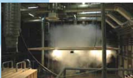
DD-VG-DN400 Kühlfall \Delta T = - 10K V = 3'000 \text{ m}^3/\text{h} Strahlrichter in Kühlfallstellung – 80 mm Hub
