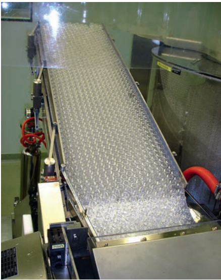
Bild 1d: Flutung von Vials mit «Leitfähige Luft»
